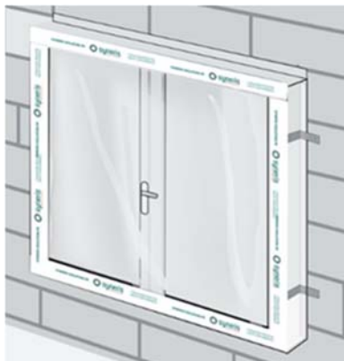
Figure 2 : Protection des éléments de construction
