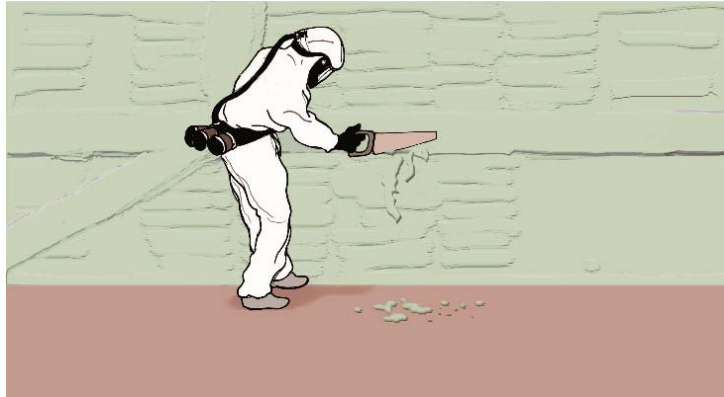
Figure 12 : Écrêtage des surépaisseurs
